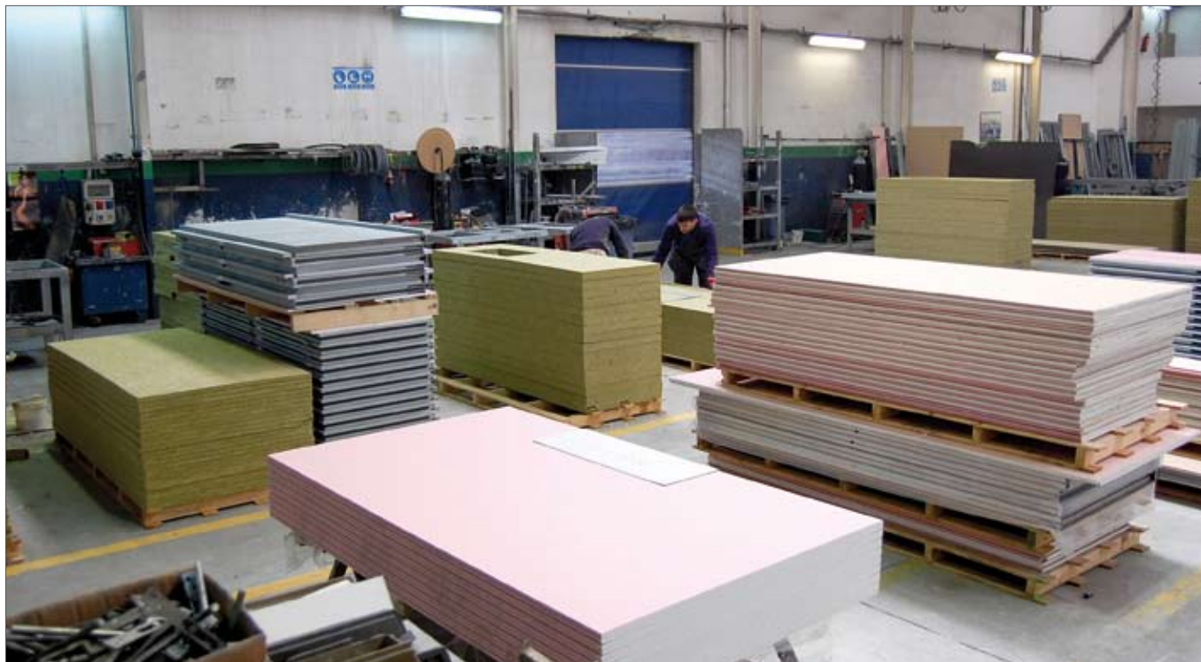
↳ Lã de rocha e placas de gesso são alguns dos componentes que conferem características de segurança e protecção às portas fabricadas pela Porseg.
